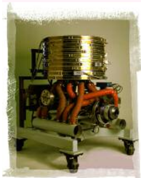
1991 Three Layer Spiral Mandrel IBC Die
